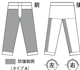
防護ズボンは、チェンソーが布地の裏面に接触した時、防護繊維が引き出されスプロケットに絡みつくことで瞬時にソーチェンの回転を停止させる機能を持ちます。防護材は左記に示す灰色前の部分をカバーしており、防護繊維やベースとなる生地等が6～9層ほどになっています。防護繊維には、ソーチェンが当たっても切れにくい強靭な化繊（アラミド繊維等）が使われています。
