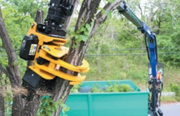
EPSILON M12Z105+GMT035で最大高12mの作業範囲。チルトして掴む・伐る・運ぶ作業が可能なトラックになり、より安全で効率的、少人数、少車両での作業を実現します。マルマテクニカ独自の油圧ポンプで、抜群の操作性を実現。是非、試乗して体感してください!!
