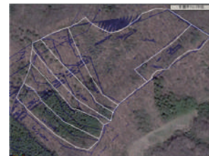
Step3. オルソ航空写真と変形した公図を参考に推定境界線を作図
